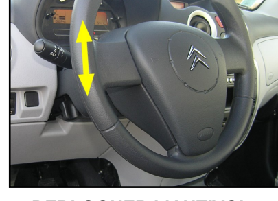
DEBLOQUER L'ANTIVOL Tournez le volant en même temps que la clef de contact pour débloquer le volant
